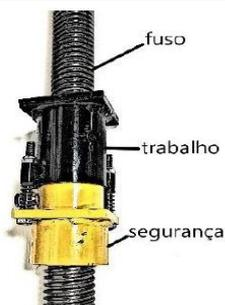
**Manutenção:** 03 pontos sinalizados que devem ser lubrificados à cada 30/45 dias, com modelo de bomba e graxa específico.
