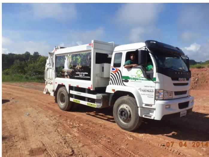
Figura 12 – Caminhão compactador utilizado na coleta de resíduos sólidos domiciliares.
